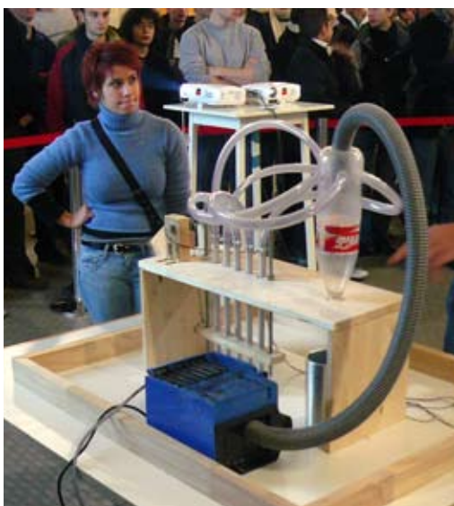
Staubsauger: Eine Saugvorrichtung zur Reisaufnahme mittels Unterdruck für Aufgabenstellung B.
